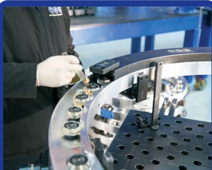
Усовершенствованная система кулачковых роликов TAG обеспечивает плавное точное вращение, точную регулировку подшипников для оптимальной производительности и технического обслуживания.
